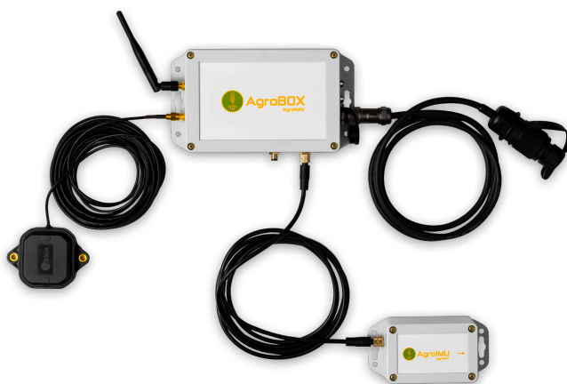
Przykład połączenia zestawu z modułem AgrolMU
